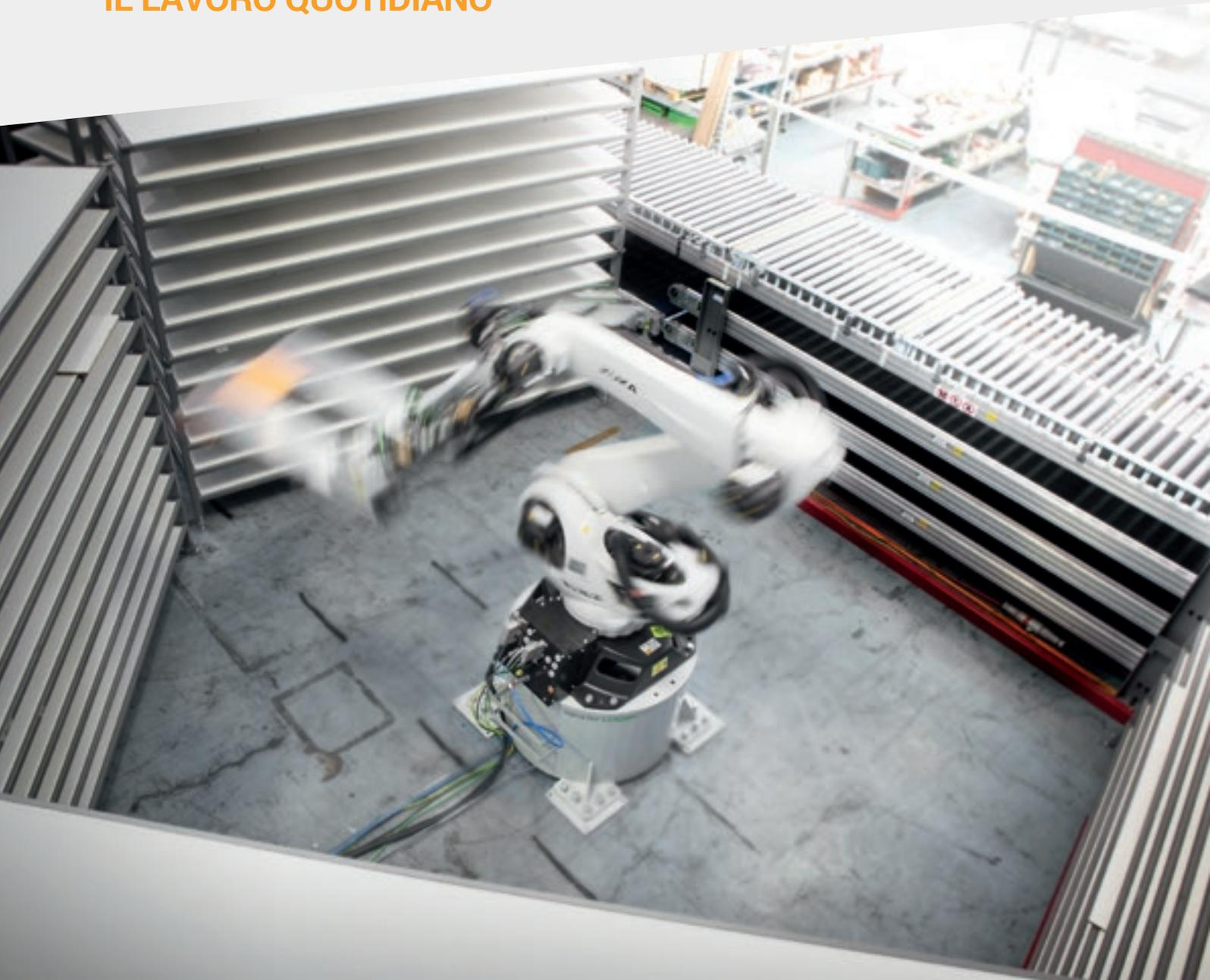
Semplificazione dei processi, riduzione di molti lavori manuali e riduzione del rischio di danneggiamento delle lastre. I robot sono soluzioni che coniugano versatilità, efficienza ed elevato ritorno d'investimento.
